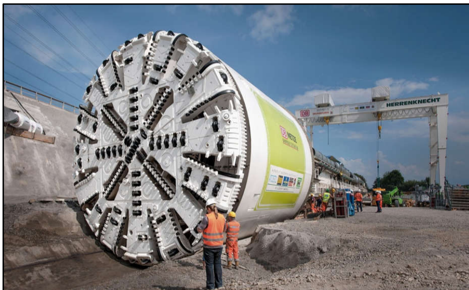
Tunneliers utilisés pour le percement de tunnels de grand diamètre dans des formations consolidées peu fracturées
