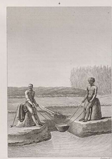
VUES ET DÉTAILS DE DEUX MACHINES À ARROSER, APPELLÉES CHÂDOUF ET MENTÂL.
