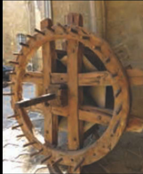
Kition-Bamboula (Chypre), puits à roue élévatrice du III e s. ap. J.-C.
